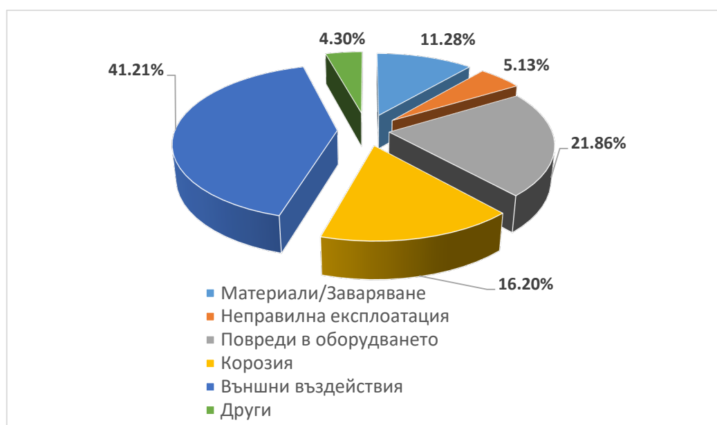
Фиг. 7. Кръгова диаграма на причинно-следствените фактори за повредата на газопреносните тръбопроводи
